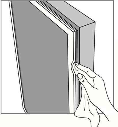
1. Entfernen Sie sichtbare Schmutzrückstände mit einem Pinsel oder trockenen Lappen. Verwenden Sie keine scharfen Gegenstände beim reinigen zwischen den Falten, weil das zu irreparablen Schäden an der Dichtung führen kann.
